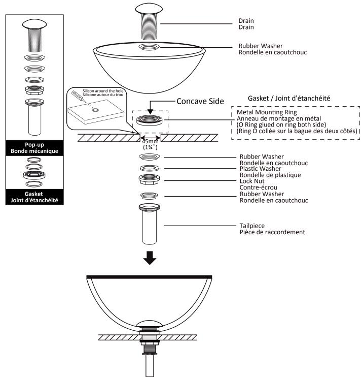
\* ATTENTION : DO NOT OVER-TIGHTEN POP-UP/GASKET WHILE INSTALLING IT TO GLASS VESSEL. ATTENTION : NE PAS TROP SERRER POP-UP/GASKET TOUT EN L'INSTALLANT À LA CUVE VERRE.
