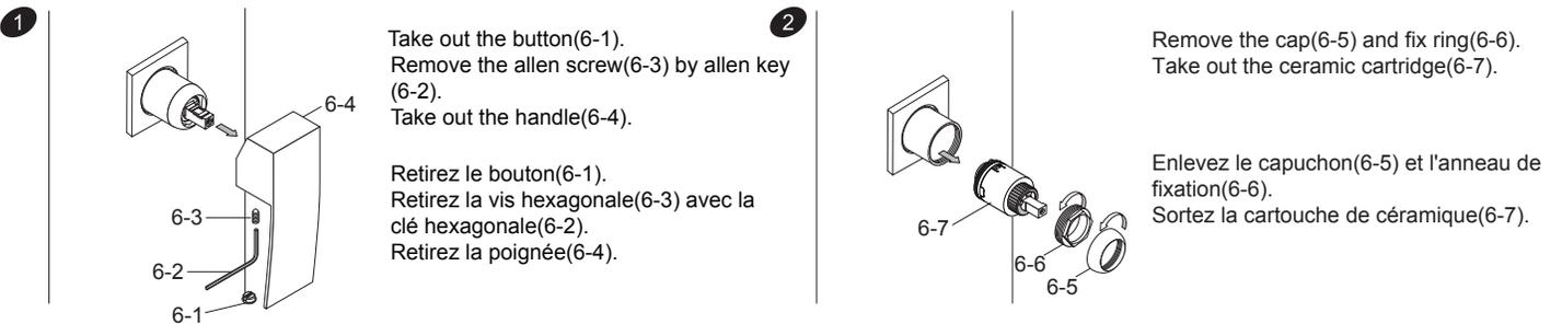
Adjusting water temperature / Ajustement de la température d'eau
