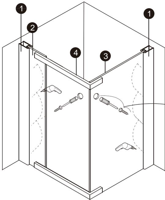
\*Percez 4 trous de 3.2mm également espacés dans les montants de mur (1) À L'INTÉRIEUR de la douche. Assurez-vous que vos trous de perçage soient à plus de 30mm du bord du verre, sinon vous risquez de briser le verre. Assurez-vous que les vis traversent l'aluminium des panneaux fixes. Fixez les panneaux fixes (2) et (3) à l'aide des vis de fixation de panneau M4x10mm (20) et des bouchons de vis de fixation du panneau fixe (21).
