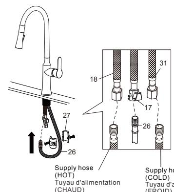
Connectez le tuyau(26) avec le connecteur rapide(17). Assemblez le poids avec les vis(27) sur le tuyau(26). Raccorder le tuyau d'alimentation(non inclus) sur le tuyau chaud(18) et le tuyau de froid(31).
