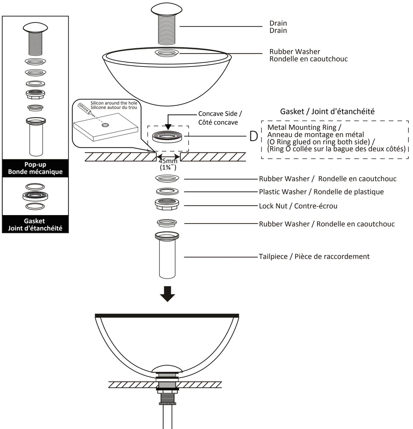
**ATTENTION : DO NOT OVER-TIGHTEN POP-UP/GASKET WHILE INSTALLING IT ON THE GLASS VESSEL SINK.**
