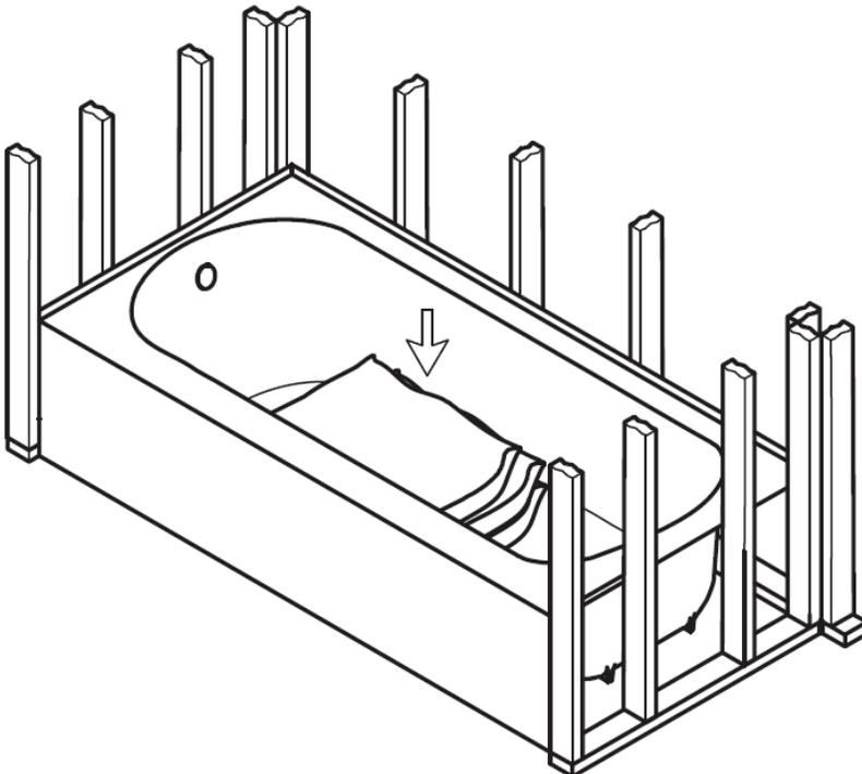
Sécurisez le bain au mur avec des vis galvanisés aux endroits pré-perçés. Appliquez un poids au milieu du bain jusqu'à ce que le mortier fige.
